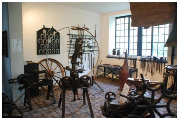
Schmiede mit Blasebalg, Amboss, Biegewalze, Stauchmaschine, Biegehorn, Ständer- und Tischbohrmaschine sowie den Werkzeugen wie Schmiedezangen, Schmiedehämmern, Gesenke, Nageleisen, Lochplatte und Locheisen
